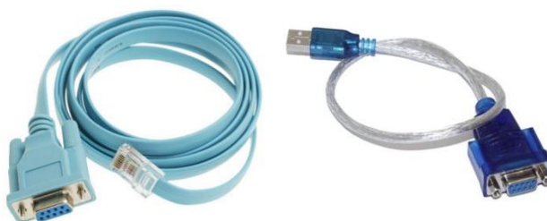
ภาพที่ 62 สายคอนโซล และ ตัวแปลง USB to RS232
