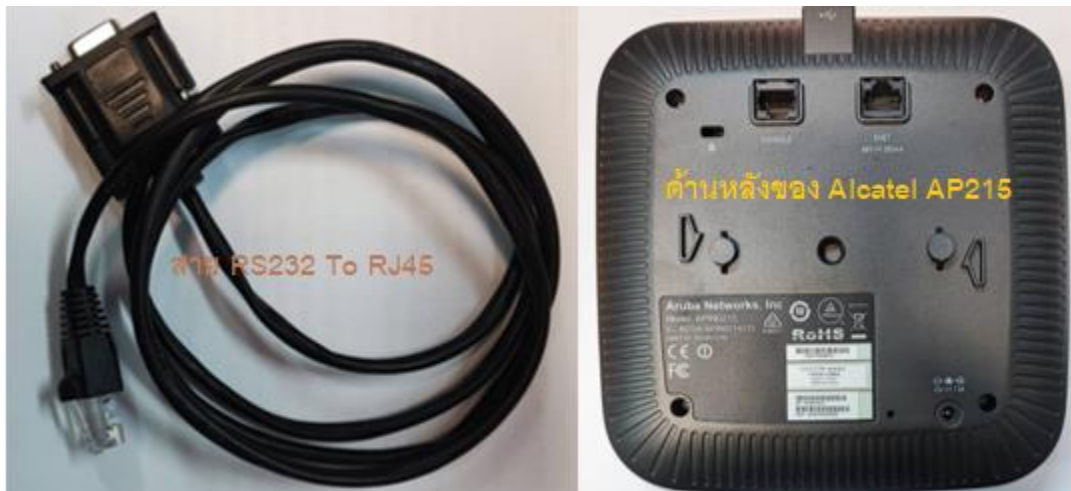
ภาพที่ 74 ลักษณะของสายสัญญาณคอนโซลและพอร์ตของ Alcatel AP215
