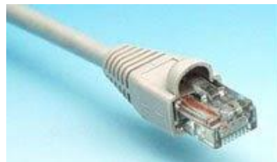
ภาพที่ 2 สาย UTP และหัวเชื่อมต่อแบบ RJ-45
